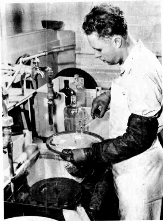
FIG. R/11. Silvering the original lacquer disc.
